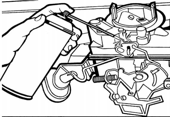
6. **Carburador:** Pulverize o carburador por dentro e por fora, cobrindo todas as peças. Repita a aplicação, se necessário.
